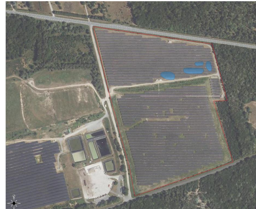
Figure 32. Localisation potentielle des dépressions (superficie totale de 2000 m²).
